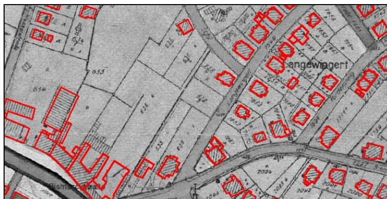
Abbildung 2: Halbautomatische Methode zur Validierung einer alten Karte (1941) mit Hilfe der ALK-Daten [V03].
